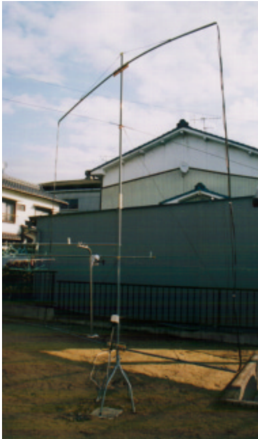
写真1. ループアンテナ全景
