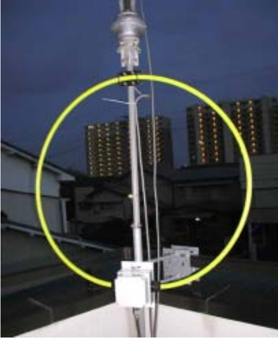
写真1. ループアンテナ全景
