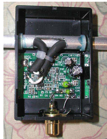
写真4. アンテナ給電部
